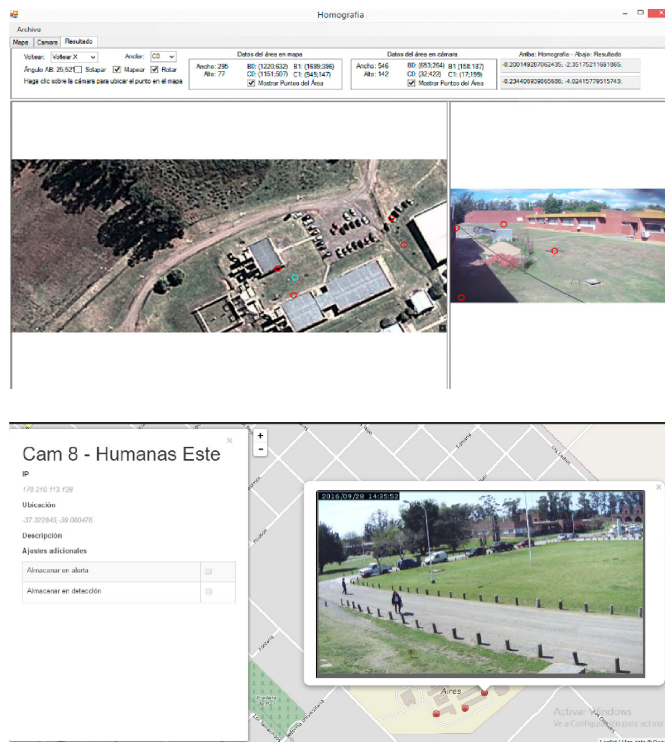
Figure 4 – (arriba) Herramienta para configuración y calibración de cámaras (abajo) vista del portal WEB para acceder a un flujo de video.
