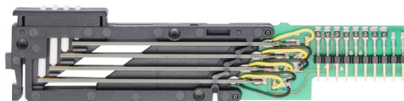
Figura 4 – Celda braille táctil de 8 puntos. Fuente: (Metec AG, 2021)
