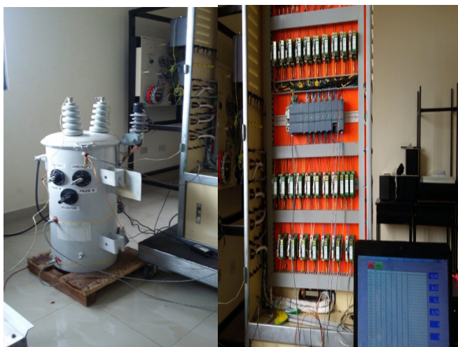
Figura 2 – Equipos empleados a) Transformador tipo tanque, b) Módulo para captura de datos. Fuente: Elaboración propia
