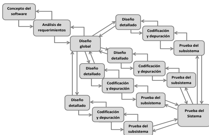
Figura 1 – Modelo en cascada con subproyectos. Fuente (McConnell, 1997,p.158)
