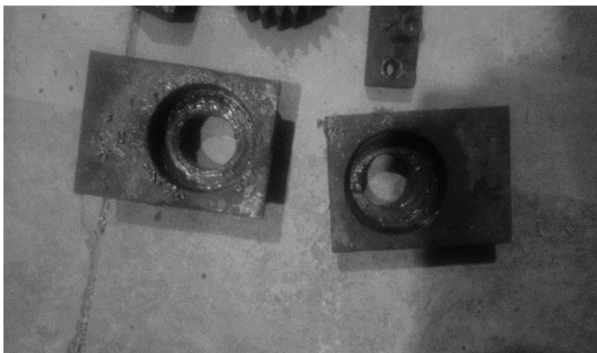
Figura 3 – Desgaste de fallas de rodamientos
