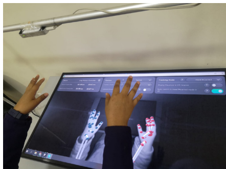
Figura 1 – Dispositivo de Tracking Óptico Leap Motion. Nota: El gráfico muestra el kit Leap Motion
